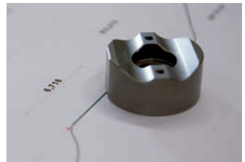
6. Fertiges Teil mit Messprotokoll
