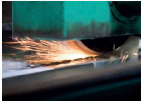
3. Vollautomatischer Schleifprozess für Profilschleifen
